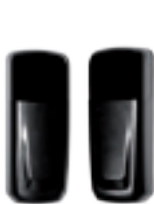
Envägsfotocell Extra 625 • 24 V DC, IP 54 • Räckvidd 8 m • Passar till: Alla drivenheter
