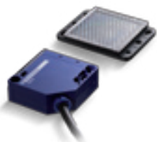
Reflektorfotocell Extra 628 • 24-240 V AC, 12-240 V DC, IP 54 • Räckvidd 5 m • Kan endast användas som impulsgivare
